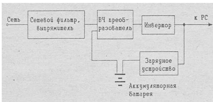
на инвертор и с него на выход устройства. Необходимость применения преобразователя обусловлена тем, что значительные изменения напряжения в сети преобразуются в относительно малые изменения высокочастотного сигнала на выходе (электроника PC более чувствительна
